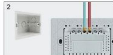
2. Conectează firele conform diagramei de instalare și strângă șuruburile
