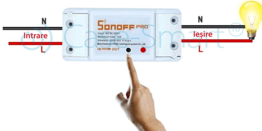
Apasă repede de 3 ori pe butonul negru „SET” pe dispozitivul SONOFF, led-ul roșu stă aprins pentru 3 secunde, ceea ce înseamnă că dispozitivul prin radio frecvență a fost anulat.
