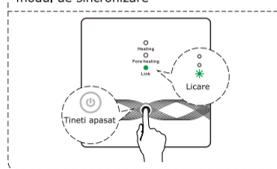
2. Cu termostatul inchis, tineti apasat 3 sec pe butonul de alimentare si butonul rotativ
