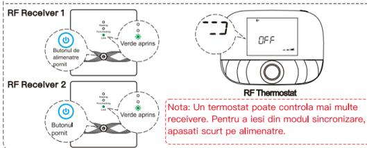
Nota: Un termostat poate controla mai multe receptoare. Pentru a iesi din modul sincronizare, apasati scurt pe alimentare.
